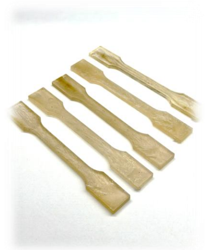
ЛИТЬЕВЫЕ ОБРАЗЦЫ ИЗ ПОЛИЭФИРСУЛЬФОНА
