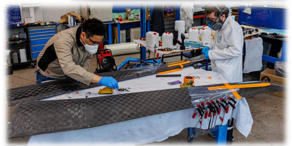
ИЗГОТОВЛЕНИЕ КРЫЛА БПЛА МЕТОДОМ ВАКУУМНОЙ ИНФУЗИИ
