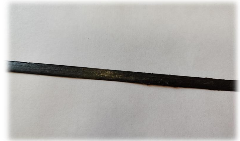
ЛЕНТОЧНЫЙ ПРЕПРЕГ ДЛЯ АВТОМАТИЗИРОВАННОЙ ВЫКЛАДКИ
