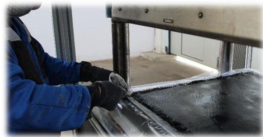
ИЗГОТОВЛЕНИЕ ПКМ МЕТОДОМ ПРЕССОВАНИЯ
