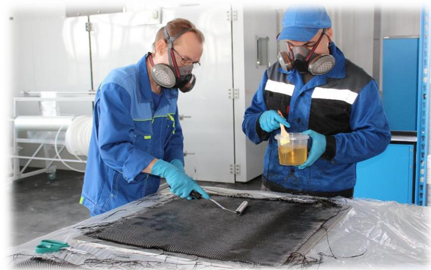
ИЗГОТОВЛЕНИЕ ПКМ МЕТОДОМ РУЧНОЙ ВЫКЛАДКИ
