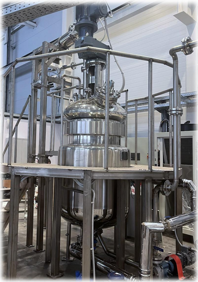
РЕАКТОР ОБЪЕМОМ 500 ЛИТРОВ
