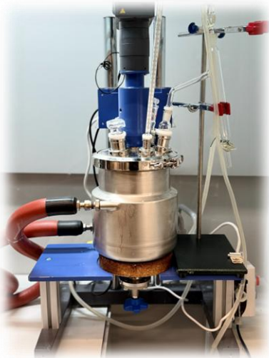
РЕАКТОР ОБЪЕМОМ 50 ЛИТРОВ
