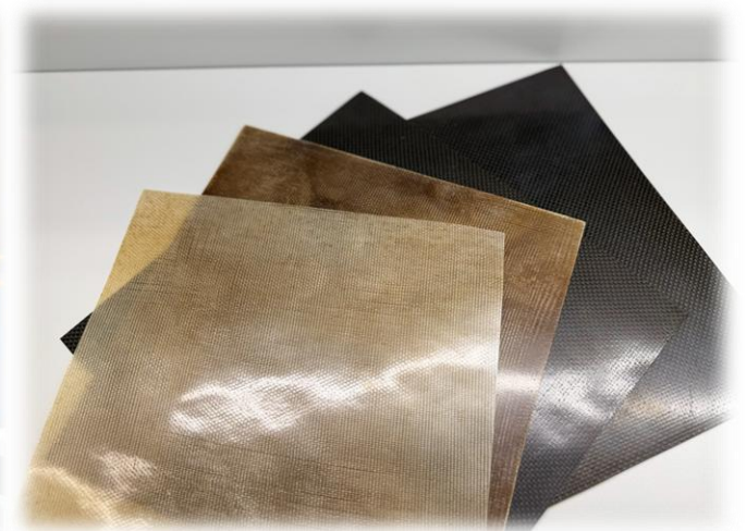
КОМПОЗИЦИОННЫЕ ПЛАСТИНЫ, ПОЛУЧЕННЫЕ МЕТОДОМ ГОРЯЧЕГО ПРЕССОВАНИЯ НА ОСНОВЕ УГЛЕРОДНОЙ ТКАНИ И СТЕКЛОТКАНИ И ПРЕПРЕГИ НА ИХ ОСНОВЕ
