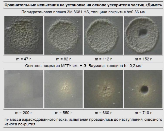
РЕЗУЛЬТАТЫ ИСПЫТАНИЙ ПОКРЫТИЯ К АБРАЗИВНОМУ ИЗНОСУ
