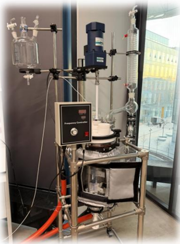
РЕАКТОР ОБЪЕМОМ 50 ЛИТРОВ
