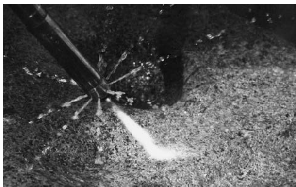
Рис. 7. Взаимодействие детонационного факела с гранитной поверхностью
