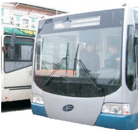
Рис. 4. Опытный образец автобуса с КЭУ «Транс-Альфа» на испытаниях, г. Вологда
