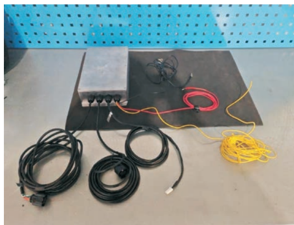
Рис. 5. Бортовой комплекс для регистрации параметров ДВС
