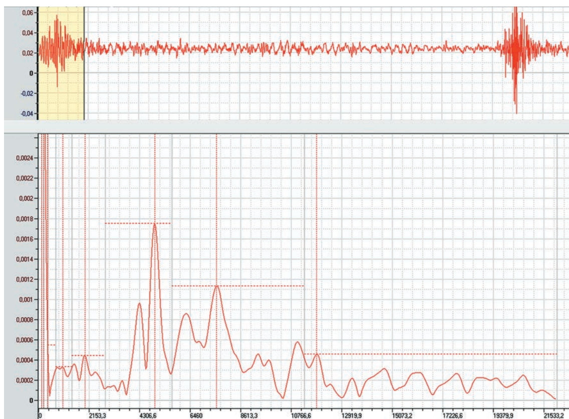
Рис. 9. Увеличенный фрагмент выборки сигнала датчика детонации KS1
