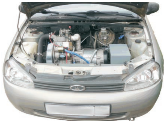
Рис. 6. Подкапотное пространство автомобиля на базе ВАЗ-1118 с экспериментальной КЭУ
