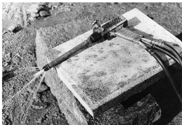
Рис. 3. Термоинструмент на обработанном гранитном покрытии с микрофакелом для запуска (струи воды имеют технологическое значение)
