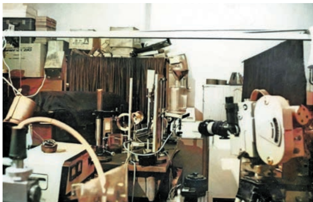
Рис. 1. Стенд для изучения теплообмена и термомеханических напряжений и деформаций в покрытиях из природных материалов
