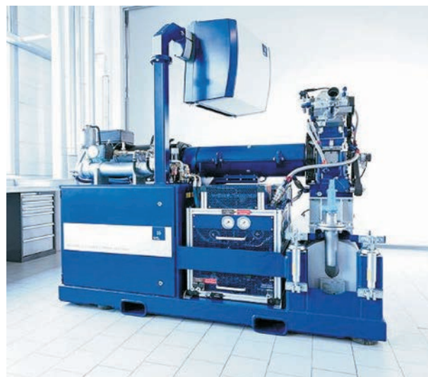
Рис. 7. Одноцилиндровый компактный испытательный стенд AVL 570
