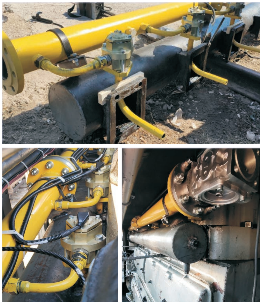
Рис. 14. Размещение газового коллектора и электрогазовых клапанов на двигателе Д50
