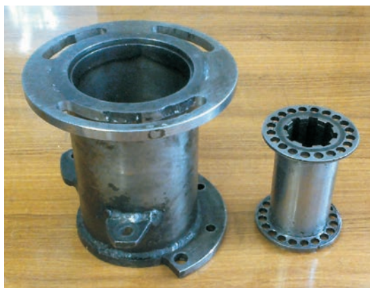
Рис. 1. Втулка привода дополнительного ТНВД и проставка крепления топливного насоса
