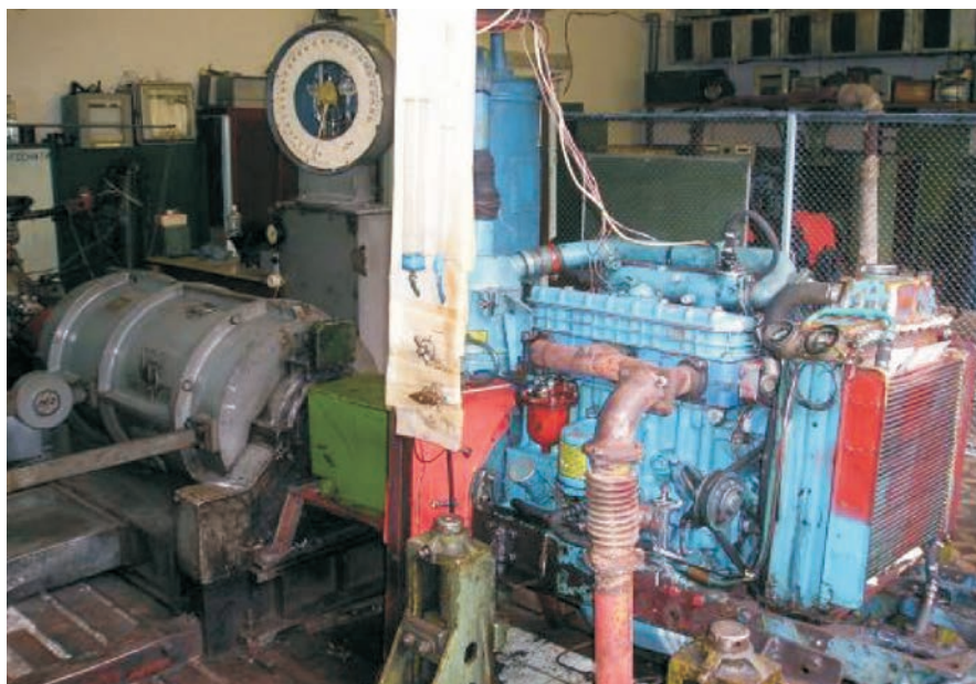
Рис. 6. Общий вид моторного стенда дизельного двигателя типа Д-243
