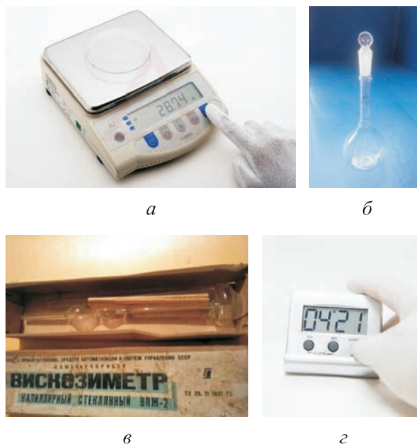
Рис. 1. Оборудование для лабораторных опытов: а — весы лабораторные VIBRAAJH-620CE; б — пикнометр ПЖ2-10-КШ 7/16; в — вискозиметр ВПЖ-2; з — электронный секундомер
