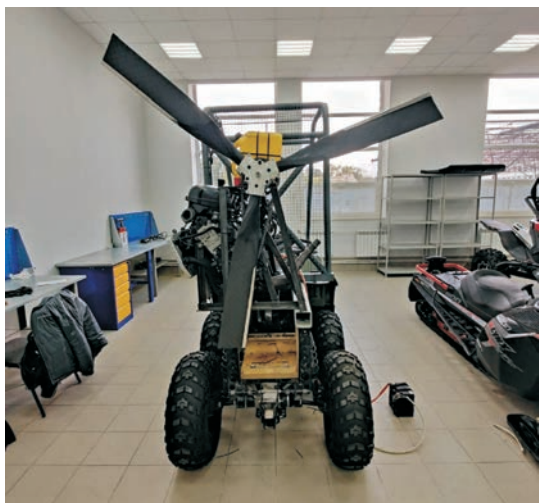
Рис. 1. Общий вид трехлопастного маршевого винта «Барракуда» на экспериментальном стенде
