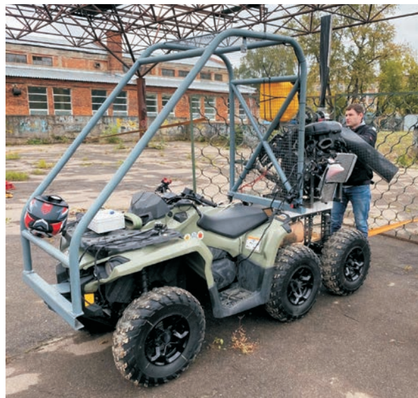
Рис. 5. Испытания по определению аэродинамических характеристик МВ «Барракуда»
