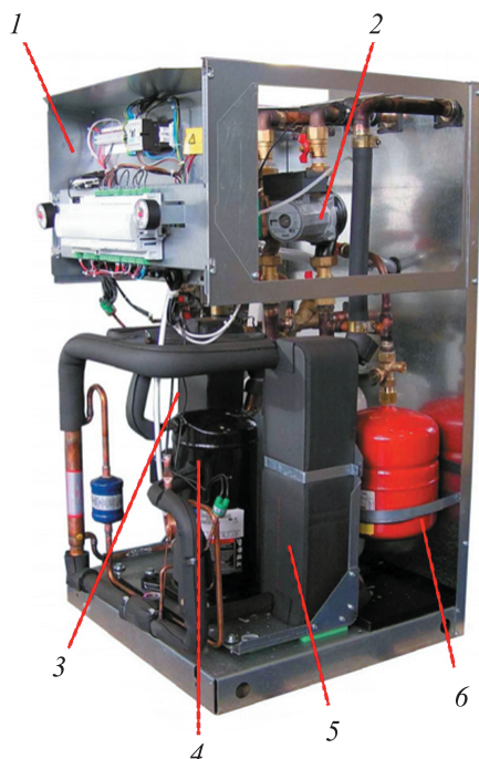
Рис. 2. Тепловой насос Dimplex LAV 14ITR: 1 — панель управления; 2 — циркуляционный насос; 3 — конденсатор; 4 — компрессор; 5 — испаритель; 6 — расширительный бак
