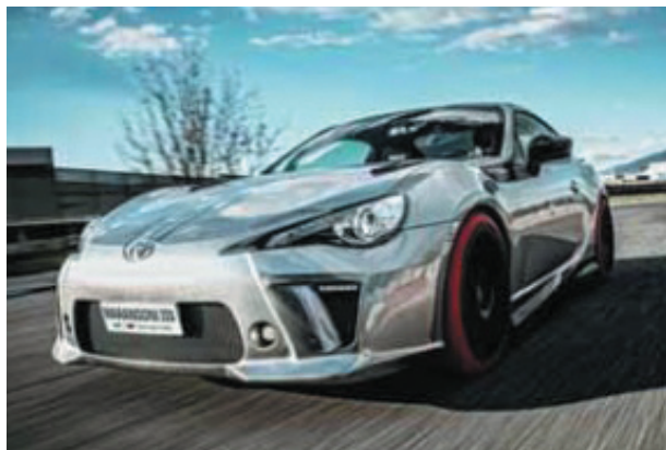
Рис. 2. Спорткар Marangoni Toyota GT86-R, работающий на аммиаке и сжиженном нефтяном газе
