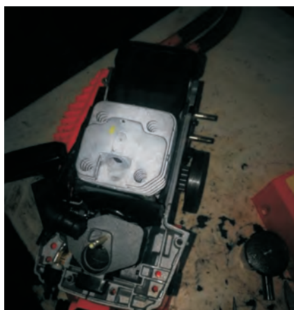
Рис. 2. Установка поршня с медно-марганцевой поверхностью в двигатель 1Д 4,5/3,5
