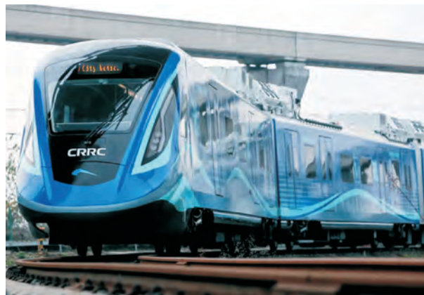
Рис. 4. Пассажирский поезд на водородном топливе корпорации CRRC
