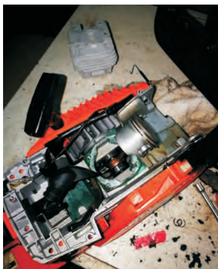
Рис. 2. Установка поршня с медно-марганцевой поверхностью в двигатель 1Д 4,5/3,5
