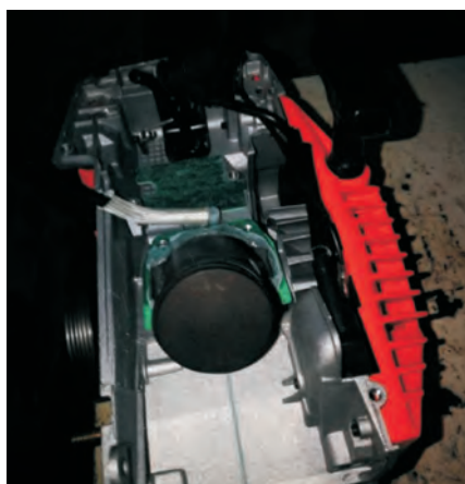
Рис. 2. Установка поршня с медно-марганцевой поверхностью в двигатель 1Д 4,5/3,5
