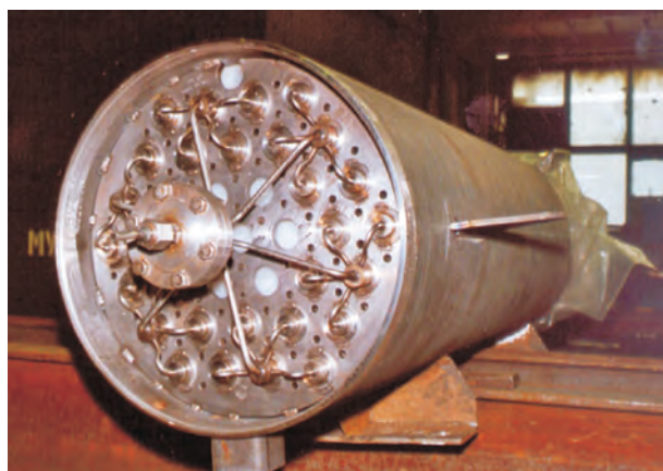
Рис. 7. Опытный образец интерметаллидного накопителя водорода, разработанный ОАО «Специальное конструкторское бюро котлостроения» (г. Санкт-Петербург)
