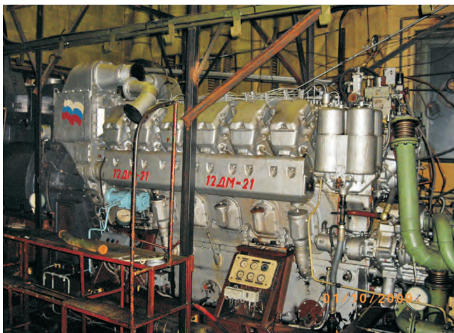
Рис. 6. Дизель-генератор воздухонезависимой энергетической установки мощностью 1500 кВт на базе дизеля 12ЧН 21/21
