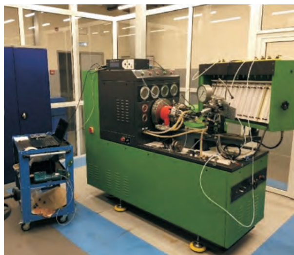
Рис. 1. Топливный стенд для испытания систем Common Rail
