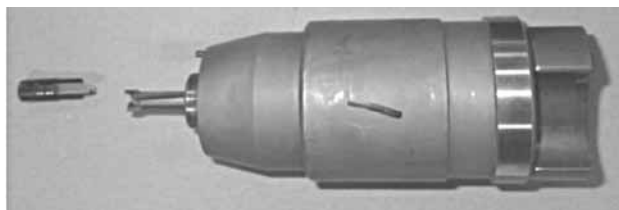
Рис. 21. Направляющая штока отсечного клапана (шток сломан)
