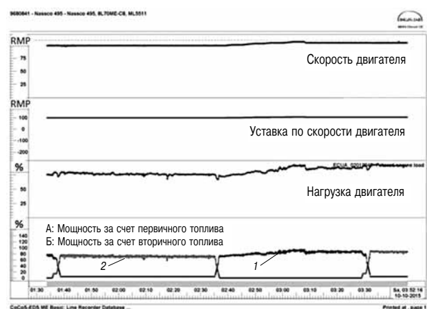
Рис. 15. Записи параметров при испытаниях двигателя на газе; нижние кривые показывают расход жидкого топлива (1) и газообразного топлива (2)
