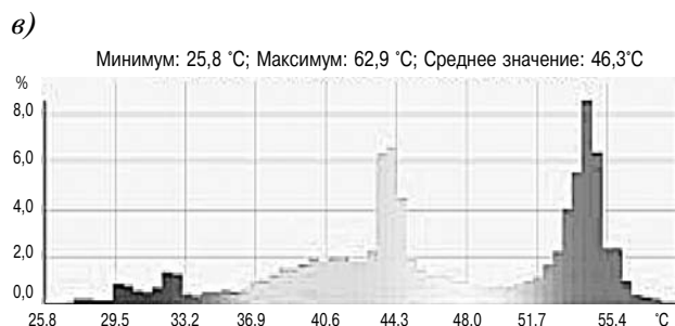
Рис. 3. Измерение температуры по термограмме: а — термограмма; б — изображение в видимом свете; в — гистограмма температур
