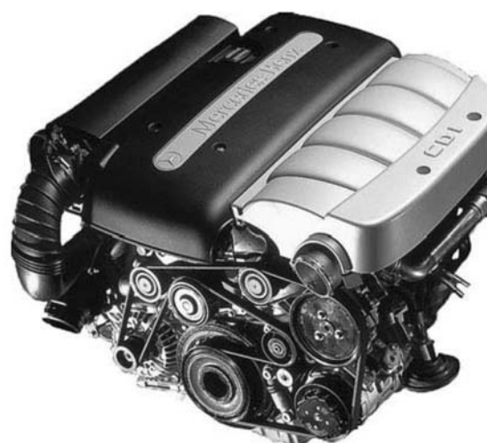
Рис. 5. Двигатель OM646 DE22LA для метода CEC-L-99-08
