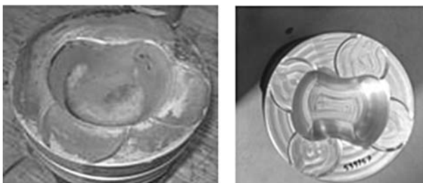
Рис. 10. Пример формы камеры в поршне
