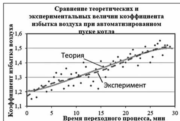
Рис. 10. Расчетные графики параметров топочных процессов на пусковых режимах
