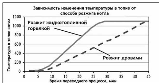
Рис. 10. Расчетные графики параметров топочных процессов на пусковых режимах
