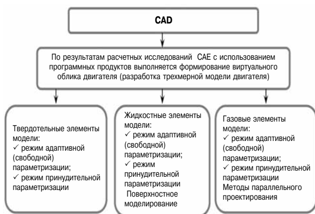
Рис. 2. Структурная схема системы CAD
