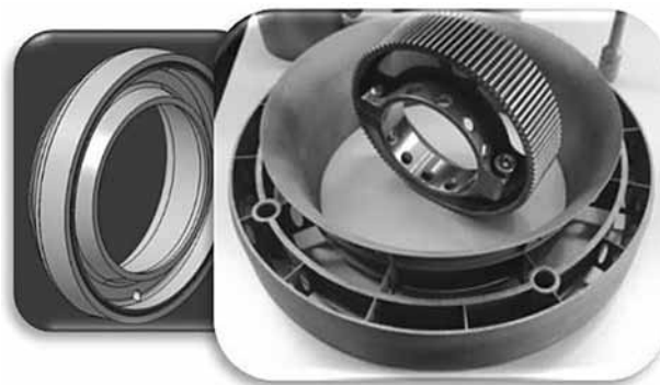
Рис. 13. Загрузочная воронка облегченного типа
