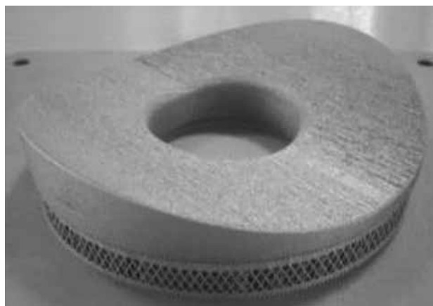
Рис. 16. Детали для гибочного инструмента
