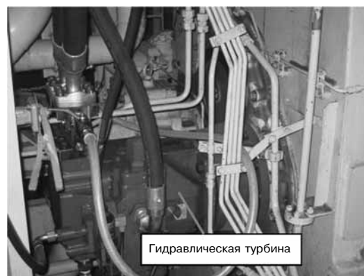
Рис. 2.4. Гидравлическая турбина на коленчатом валу
