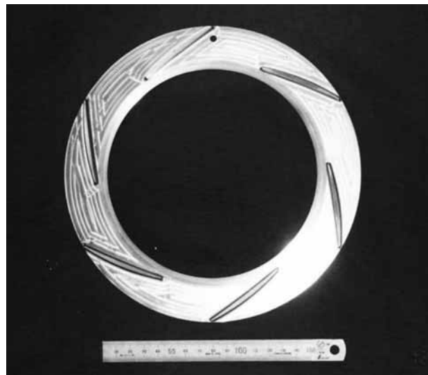
Рис. 1.9. Лопаточный диффузор с малым числом лопаток
