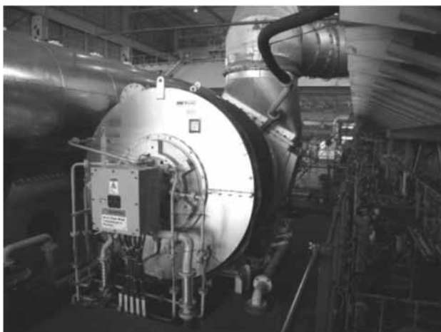
Рис. 1.18. Гибридный ТК на двигателе UEC60LSE-Eco-A2
