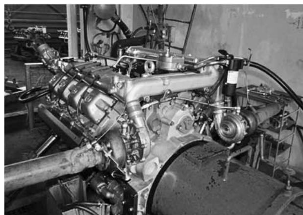
Рис. 1. Газовый двигатель КамАЗ 820.62-300 на испытательном стенде
