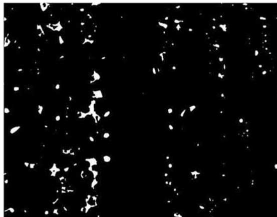
Рис. 2. Типичный вид частиц Sn на срезе
