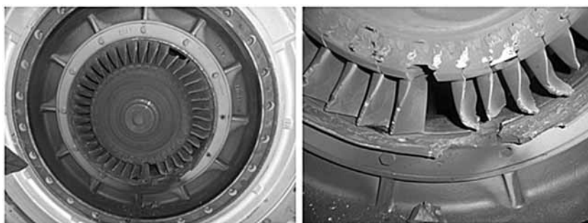
Рис. 6. Повреждения турбинной части ТК
