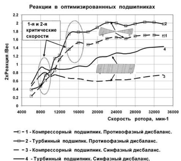
Рис. 6. Динамические реакции в подшипниках при повышенных дисбалансах
