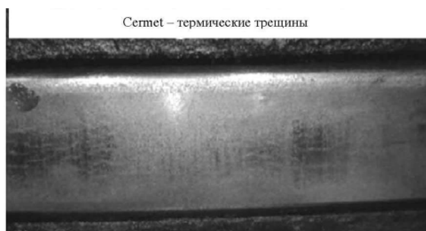
Рис. 23. Двигатель 6S60MC, проработавший долгое время на дистилляте с покрытием поршневых колец Cermet. (покрытие Cermet имеет незначительную сетку трещин)
