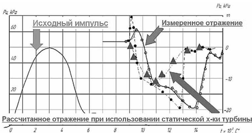
Рис. 5. Взаимодействие импульса с осевой турбиной при 7500 об/мин:
