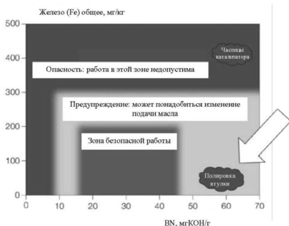
Рис. 25. Отрабатываемое цилиндрическое масло: безопасная зона по критерию «BN/Железо» для масла 70 BN и топлива с содержанием серы менее 0,1 % [11, 4]
