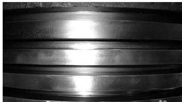
Рис. 12. Эксплуатационные испытания цилиндрических масел — новые low-BN масла после 1000 ч работы на дистилляте 0,1 % S (поверхность канавок — чистая)
