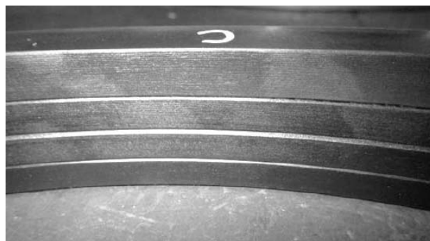
Рис. 13. Эксплуатационные испытания цилиндрических масел — новые low-BN масла после 1000 ч работы на дистилляте 0,1 % S (обратная сторона поршневых колец — чистая)
