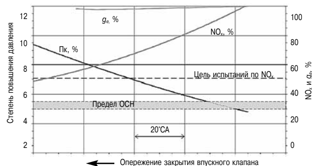
Рис. 2.4. Влияние цикла Миллера на \pi_k и эмиссию \text{NO}_x
