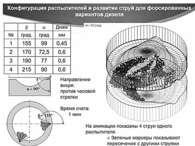
Рис. 5. Пример визуализации распространения струй в КС и оптимизации сопловых отверстий
