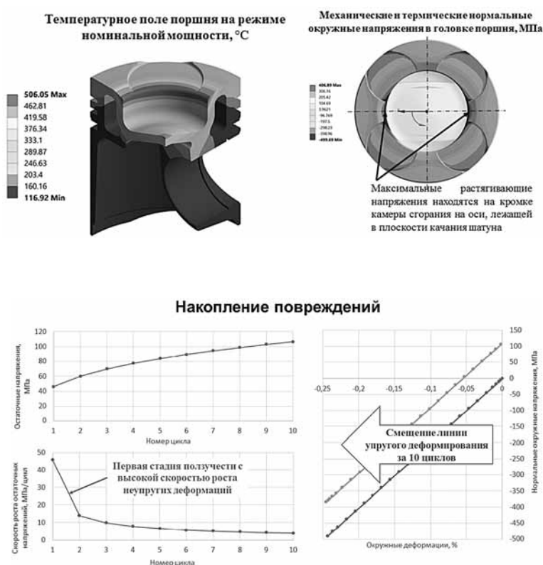
Рис. 15. Температурное поле и поля суммарных напряжений в стальном поршне дизеля ЧН13/15 при уровне форсирования ( p_e = 35 бар и p_c = 300 бар), цикл накопления остаточных деформаций и остаточных напряжений в кромке камеры сгорания
