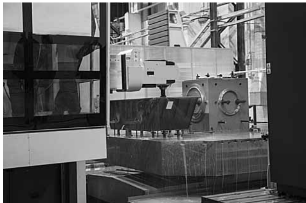
Рис. 4. Горизонтальный расточно-фрезерный станок с ЧПУ WRD 1700, «TOS Varnsdorf», Чехия
