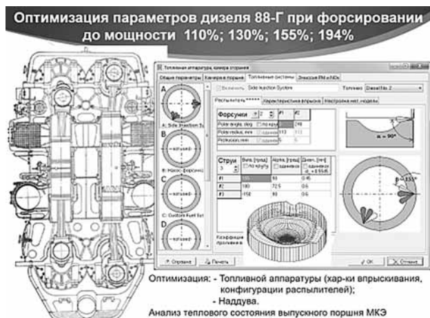
Рис. 4. Конструкторские особенности дизеля 18ДН23/2×30
