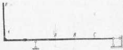
Фиг. 39. Схема установки для экспериментальной проверки свойства взаимности перемещений.
