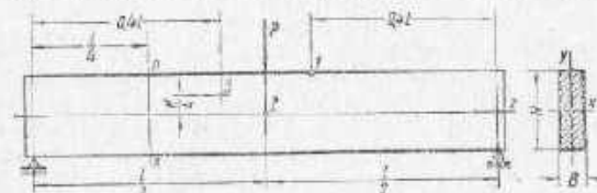
Фиг. 24. Испытываемый брус (балка) с указанием положения точек 1, 2 и 3, в которых устанавливаются тензомеры
