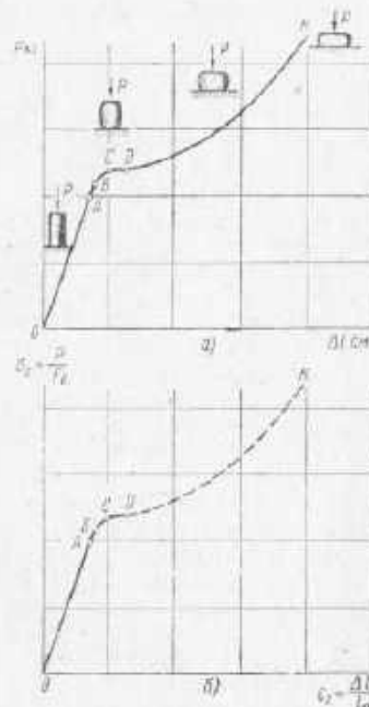
Фиг. 10. а) Диаграмма сжатия образца малоуглеродистой стали. б) Диаграмма сжатия малоуглеродистой стали.
