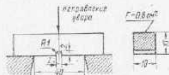
Фиг. 64. Эталон образца по ГОСТ 1524—42 для определения ударной вязкости.
