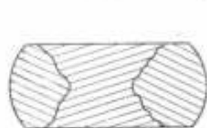
Рис. 28. Вид разрушения образца из хрупкого материала при \frac{h_0}{d_0} \approx 1
