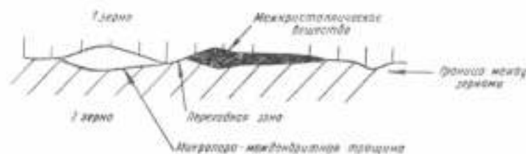
Рис. 2. Схема строения границ зерен
