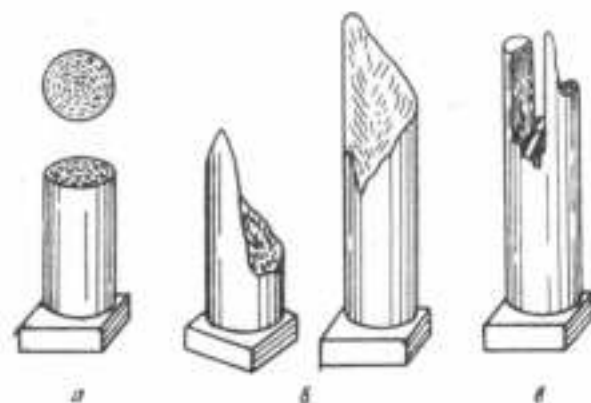
Рис. 30. Типы разрушения при кручении: а) от среза, б) от отрыва, в) от неоднородности
